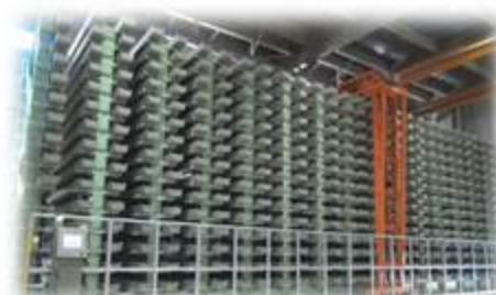
立体保管することで、任意の長尺物を安全かつスピーディに入出庫することができます。工場の上部空間を最大限に有効活用でき、在庫管理システムの導入により、適正な在庫量を常時確認することができます。
